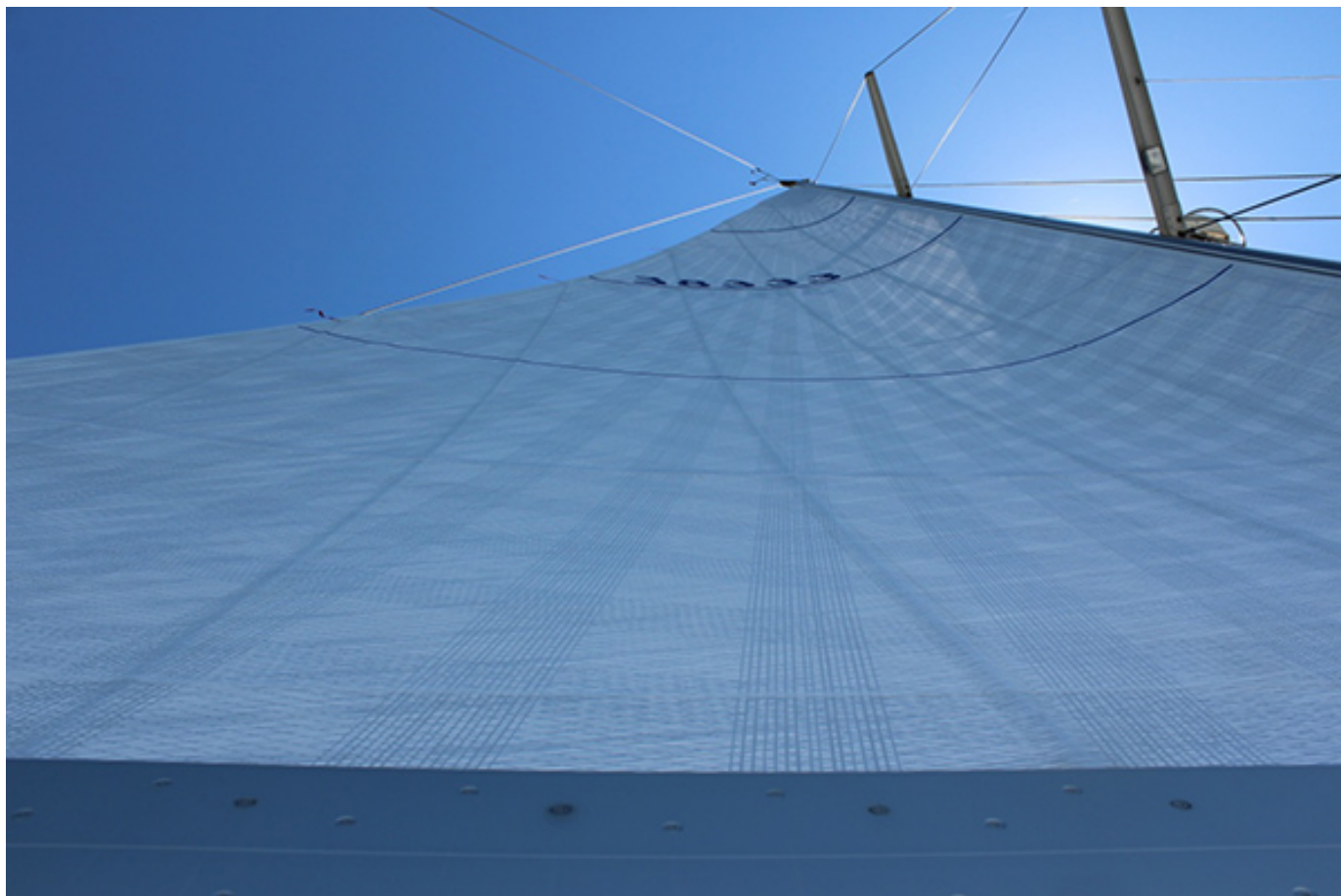
Full-batten storsejl med lodrette pinde: Dette er et MC Fusion 6500 Carbon/Technora sejl, med gennemgående RBS kulfiber pinde, der gør det muligt at opnå en facon meget tæt på den et standard racing sejl er udstyret med.
